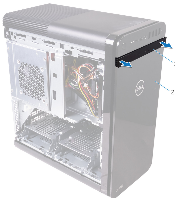
Obrázek 3. Demontáž čelního krytu optické jednotky
