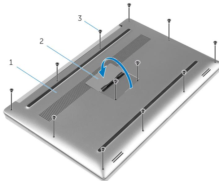
**Abbildung 1. Entfernen der Bodenabdeckung**
