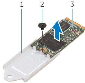
**Abbildung 12. Entfernen der SSD-Laufwerkshalterung**
