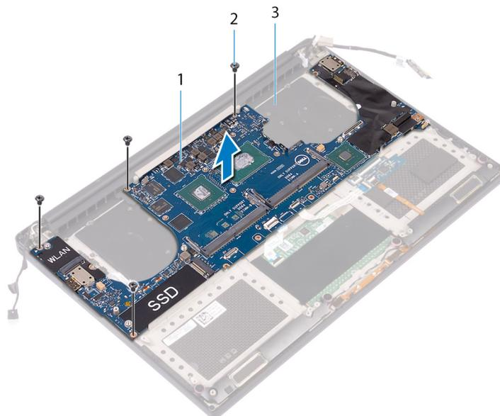
**Abbildung 23. Entfernen der Systemplatine**
