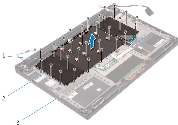
**Abbildung 28. Herausdrehen der Schrauben an der Tastatur**
