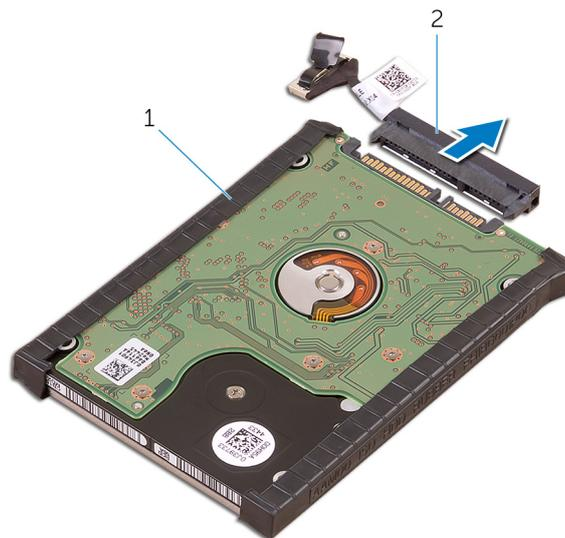
**Abbildung 9. Trennen Sie die Festplatten-Zwischenplatine von der Festplattenbaugruppe.**
