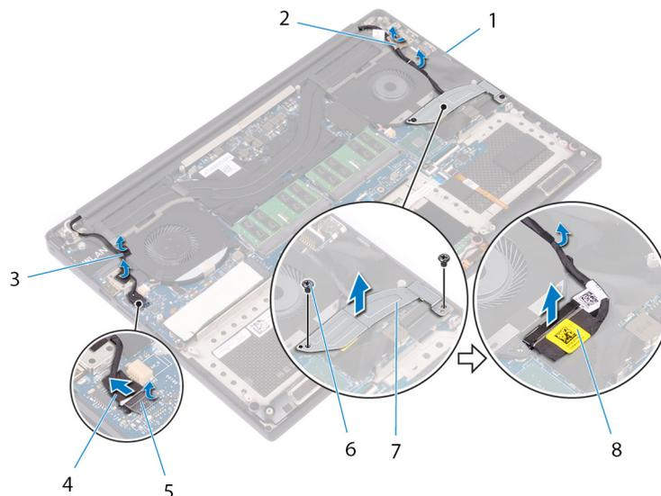
**Abbildung 29. Trennen der Kabel**
