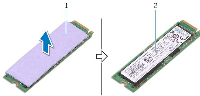
**Abbildung 14. Entfernen des Wärmeleitpads**
