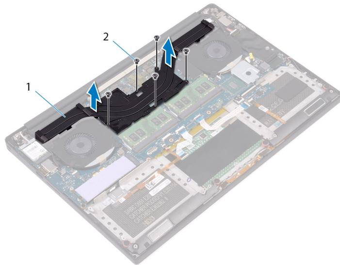
**Abbildung 21. Entfernen des Kühlkörpers**
