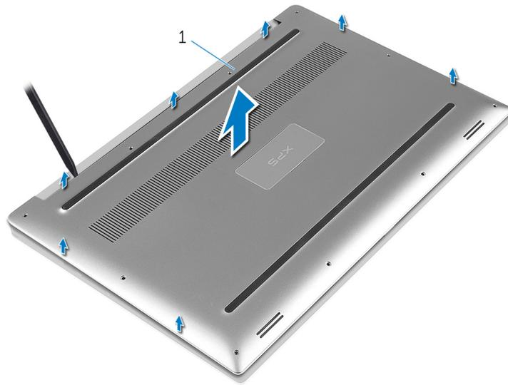
**Abbildung 2. Ziehen Sie die Bodenabdeckung vom Computersockel ab.**
