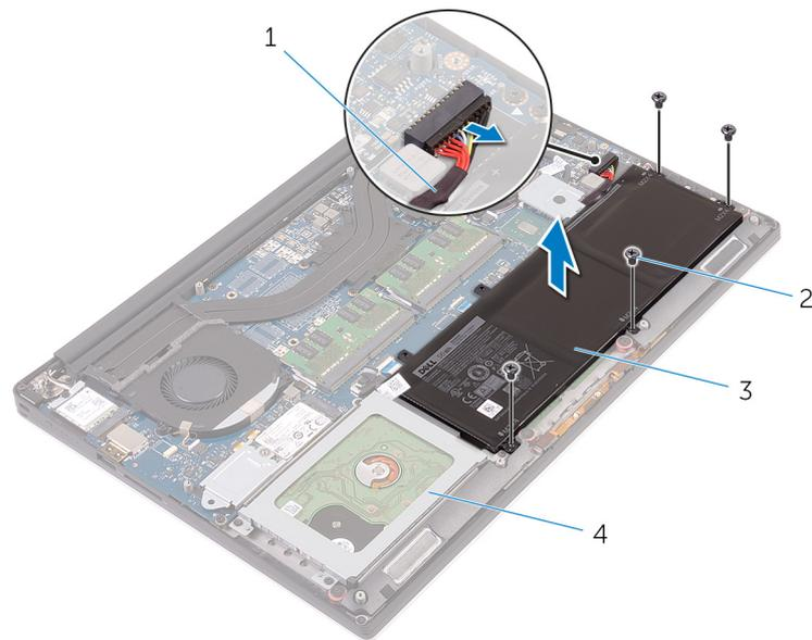
**Abbildung 3. Entfernen des Akkus**
