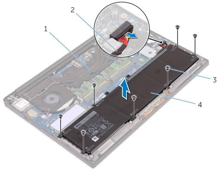
**Abbildung 4. Entfernen des Akkus**
