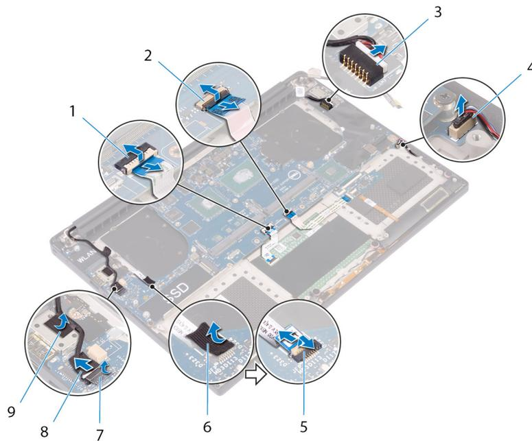
**Abbildung 22. Trennen der Kabel**
