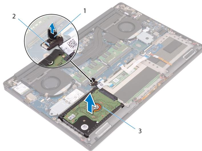
**Abbildung 8. Trennen Sie das Festplattenkabel von der Systemplatine.**
