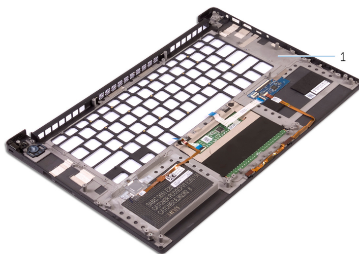
Slika 37. Uklanjanje sklopa oslonca za dlanove
