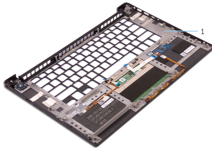
Figura 37. Como remover o conjunto do apoio para as mãos
