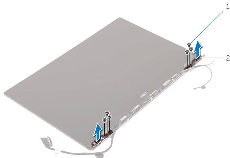
Obrázek 35. Demontáž závěsů displeje
