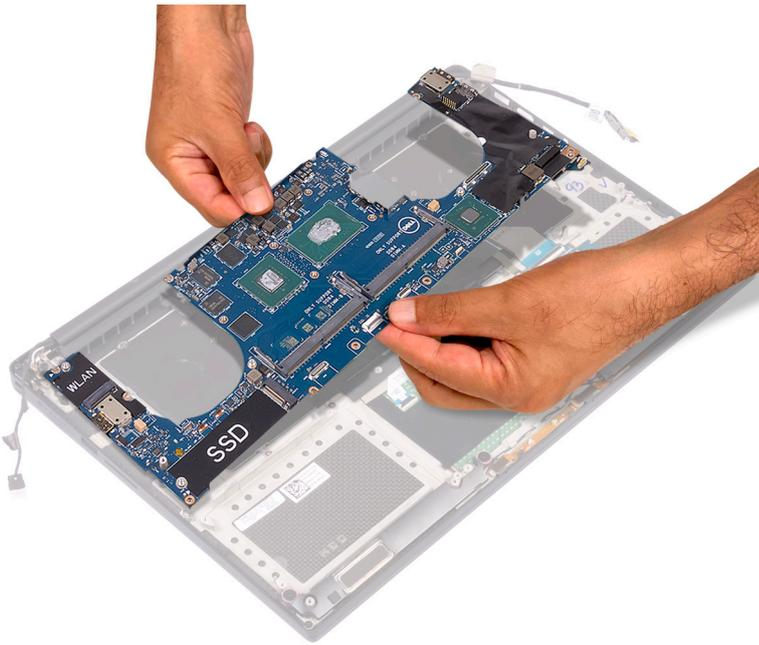
1. Richten Sie die Schraubenbohrungen der Systemplatine an den Schraubenbohrungen der Handballenstützen-Baugruppe aus.
