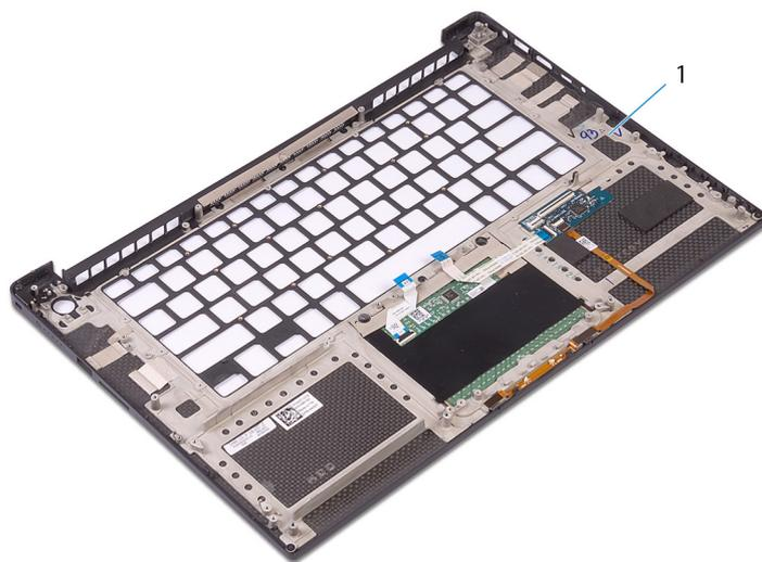
**Рисунок 36. Снятие упора для рук в сборе**
