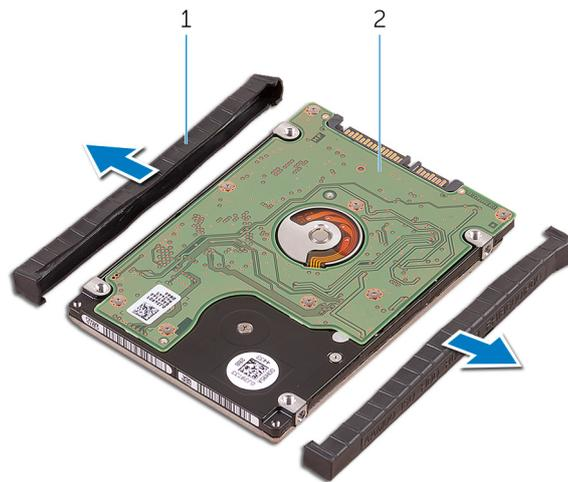
**Figura 10. Como remover a tampa do disco rígido**
