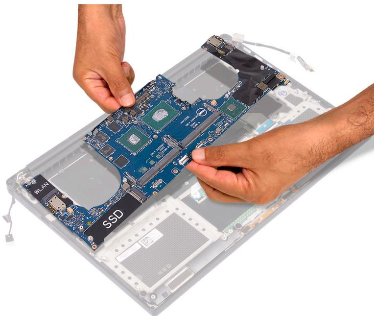
1. Alinhe os orifícios dos parafusos na montagem da placa de sistema com os orifícios dos parafusos no conjunto do apoio para as mãos.
