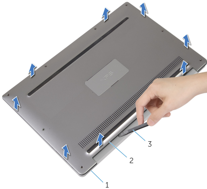
Abbildung 2. Entfernen der Bodenabdeckung
