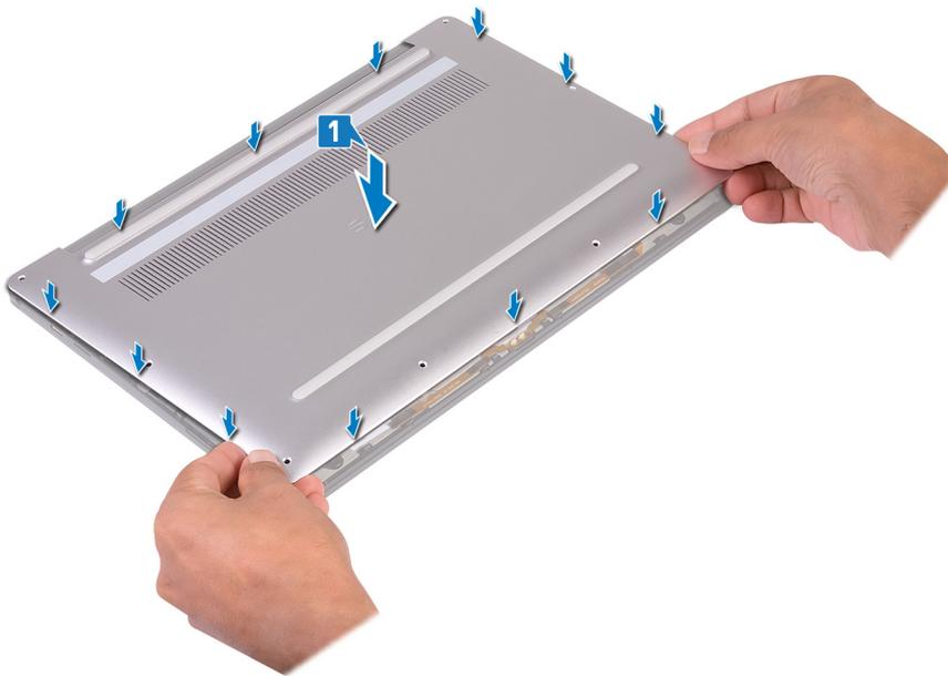
2. ベースカバーをパームレストアセンブリーに固定する8本のネジ (M2x3、トルクス) を取り付けます。
