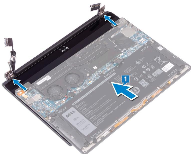
2. 位置合わせポストを使用して、ディスプレイ ヒンジをパームレスト アセンブリーに押し下げて、ディスプレイ ヒンジのネジ穴をパームレスト アセンブリーのネジ穴に合わせます。
