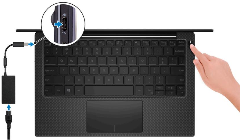
**i | OPOMBA:** Zaradi varčevanja z energijo baterije lahko baterija preklopi v način varčevanja z energijo. Priklučite napajalnik in pritisnite gumb za vklop, da vklopite računalnik.
