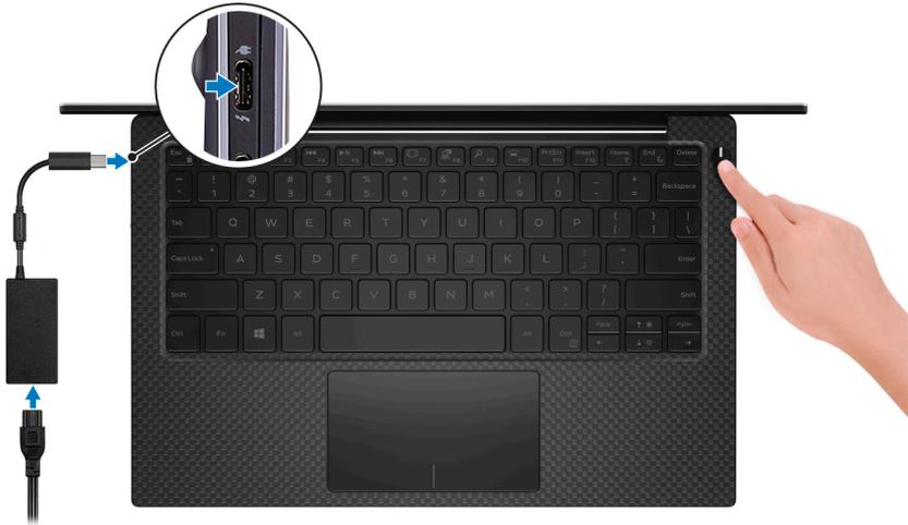
**NOTA:** Para conservar la energía de la batería, es posible que esta ingrese en modo de ahorro de energía. Para encender el equipo, conecte el adaptador de alimentación y presione el botón de encendido.
