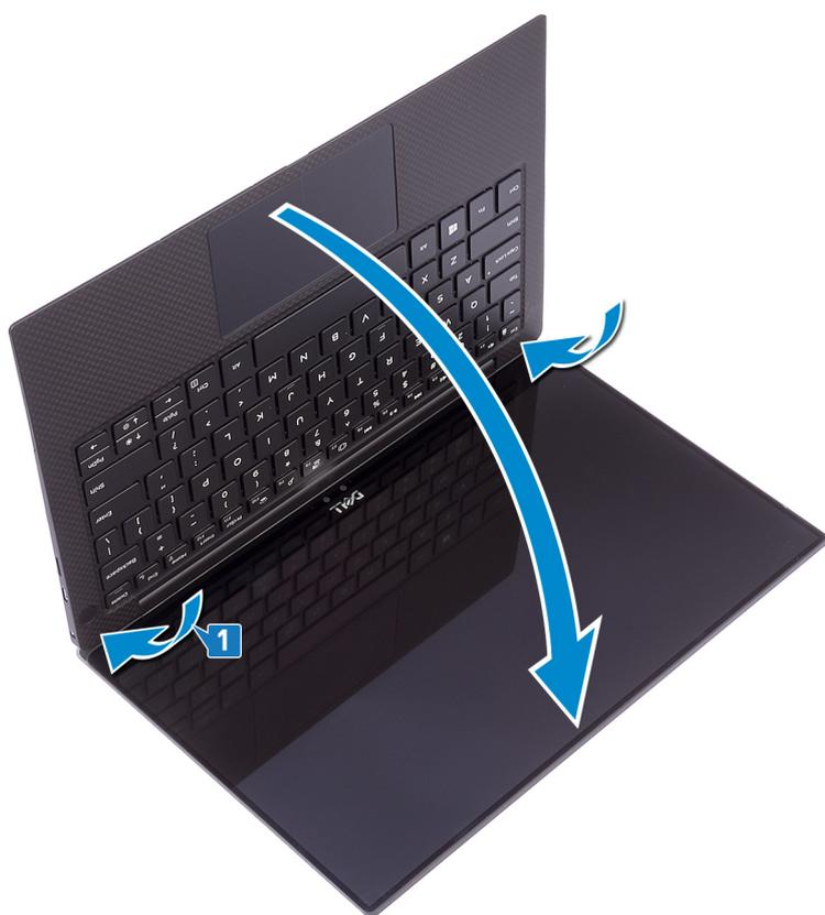
2. Utilizando os suportes de alinhamento, pressione as dobradiças do ecrã até ao conjunto do apoio para as mãos, alinhando os orifícios dos parafusos nas dobradiças do ecrã com os orifícios no conjunto do apoio para as mãos.
