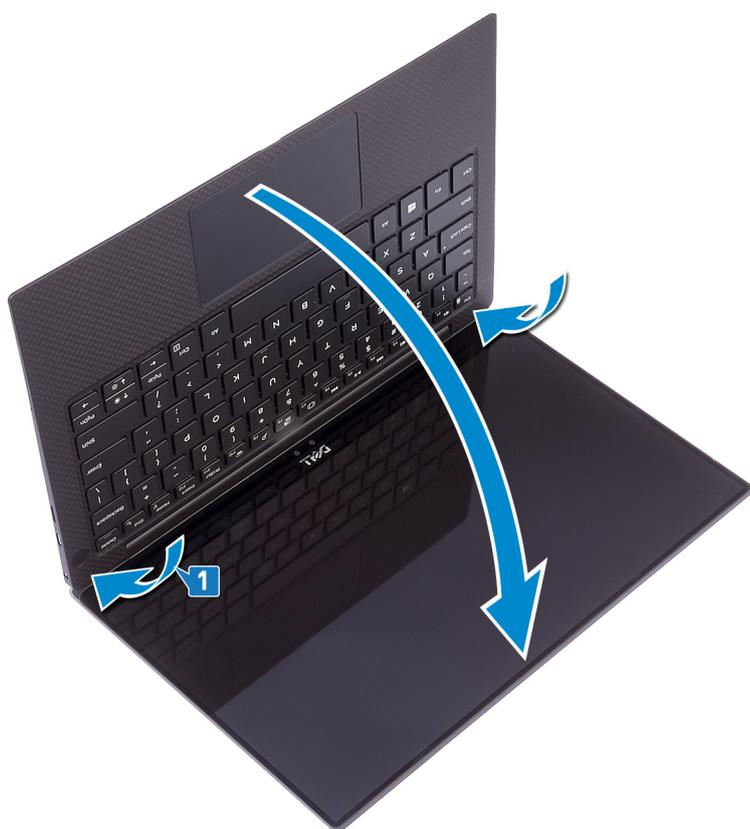
2. Dengan menggunakan tiang penyalaras, tekan engsel display ke bawah pada unit sandaran tangan, luruskan lubang sekrup pada engsel display dengan lubang sekrup pada unit sandaran tangan.
