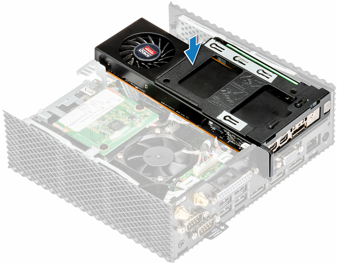
Afbeelding 16. Druk de PCIe-module omlaag
