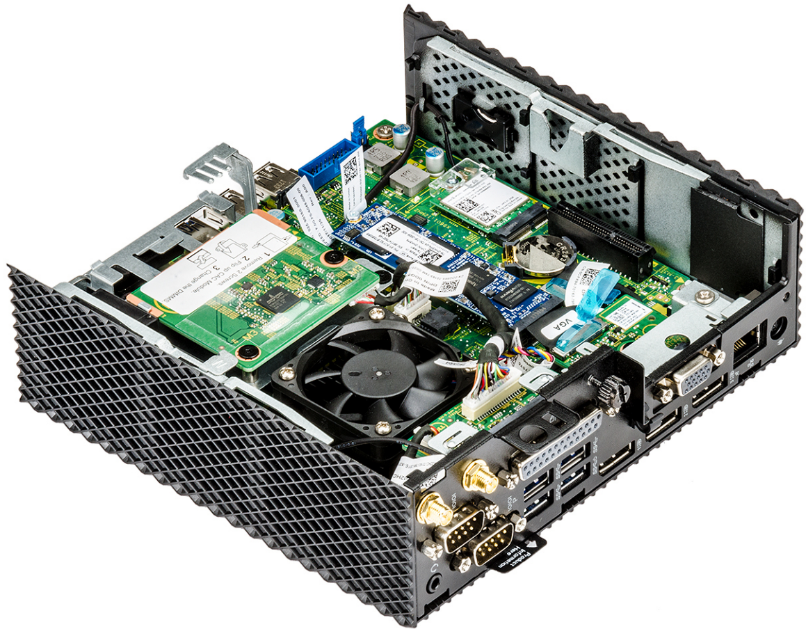
Angka 14. Modul PCIe dilepas
