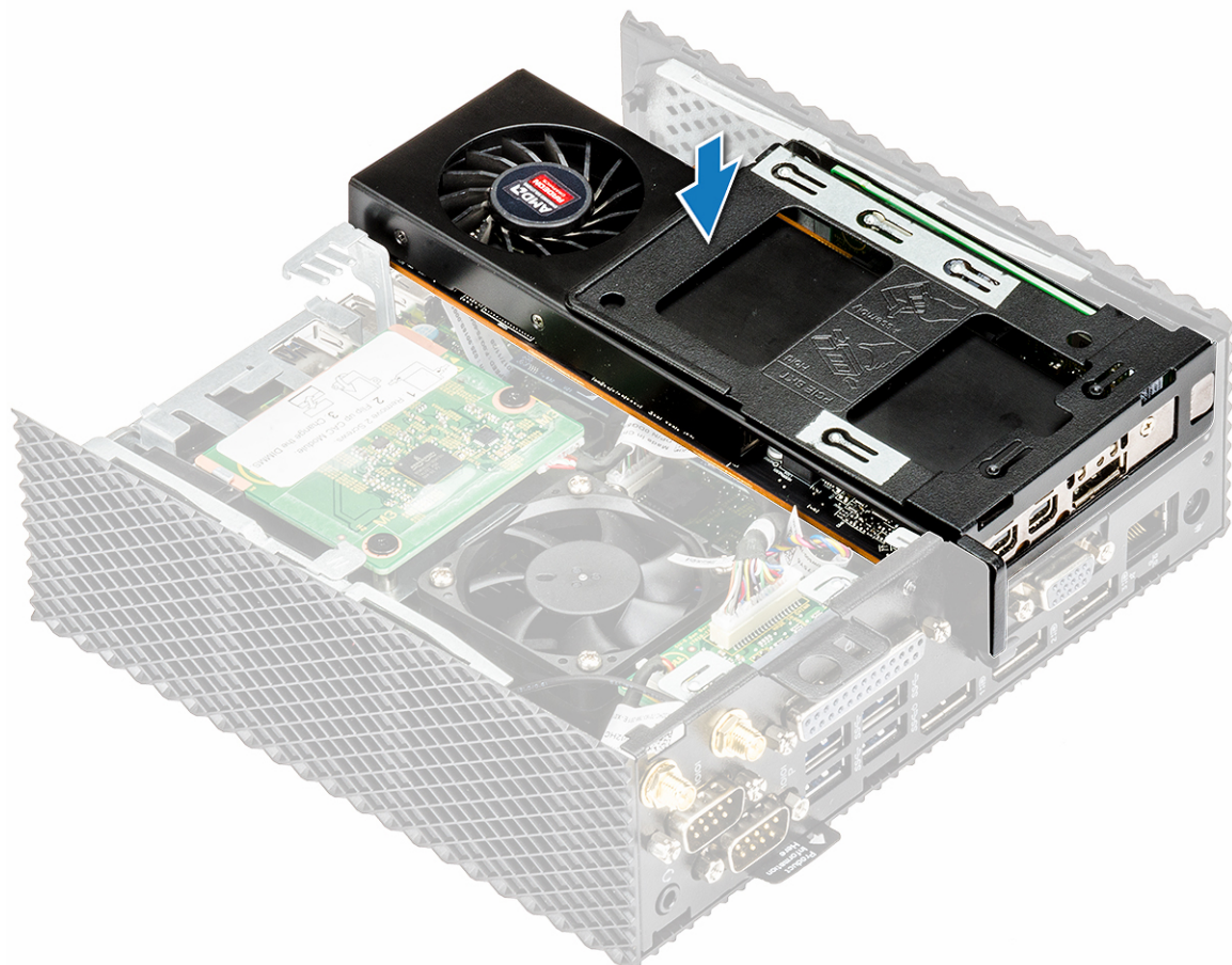
图 16: 向下按压 PCIe 模块
