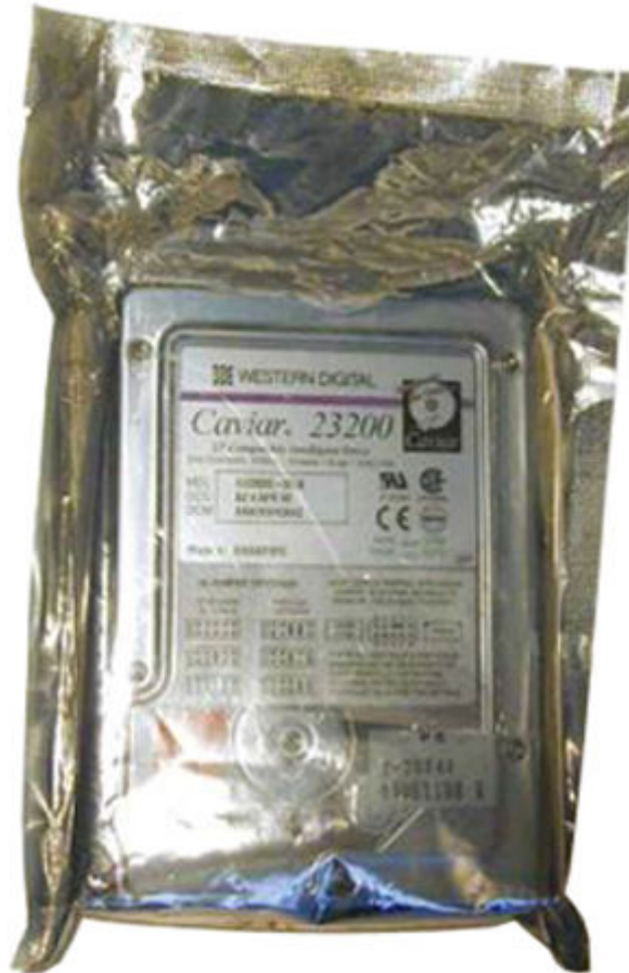
Figura 30. Embalagem contra descargas eletrostáticas
