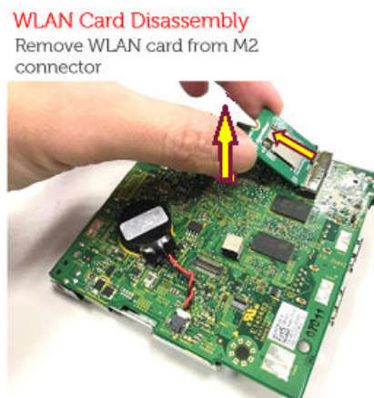
Afbeelding 35. Verwijder de WLAN-kaart uit de connector
