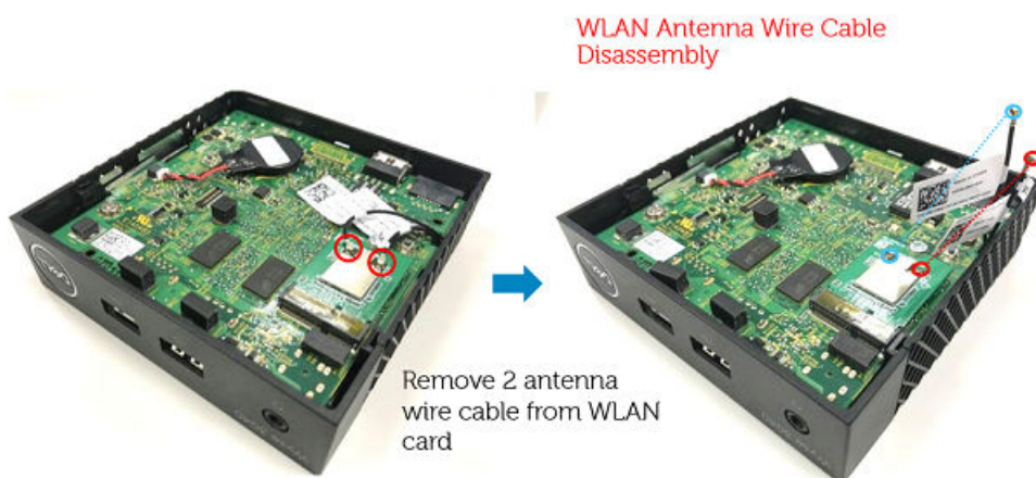
Ilustración 33. Desconecte los cables WLAN
