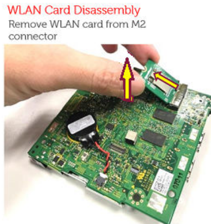
Ilustración 35. Extraiga la tarjeta WLAN del conector
