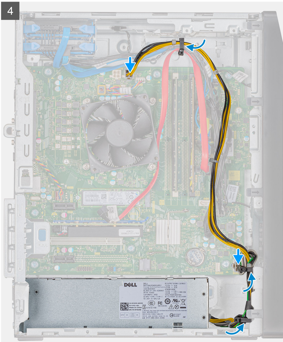
Installation du bloc d'alimentation avec un connecteur double.
