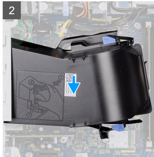
bild på installation av fläkthöljet
