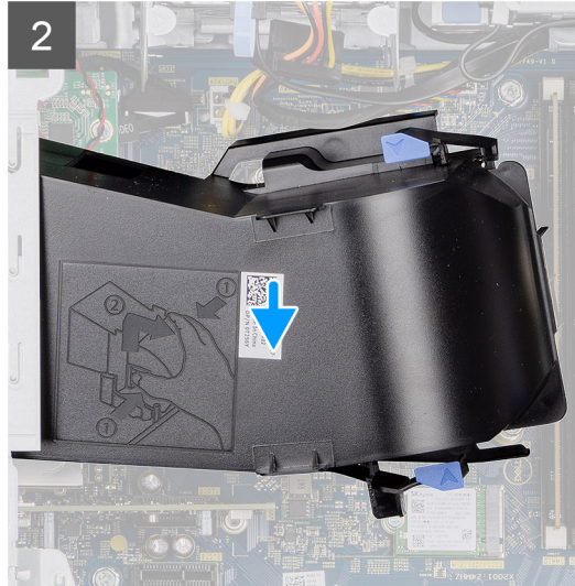
kuva tuulettimen suojuksen
