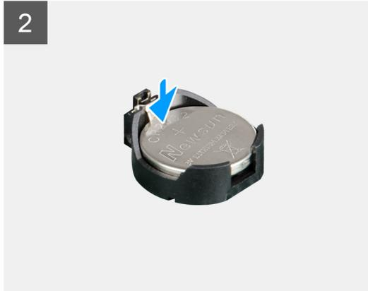
Inserire la batteria pulsante nella prese con il lato positivo (+) rivolto verso l'alto e far scattare la batteria in posizione.
