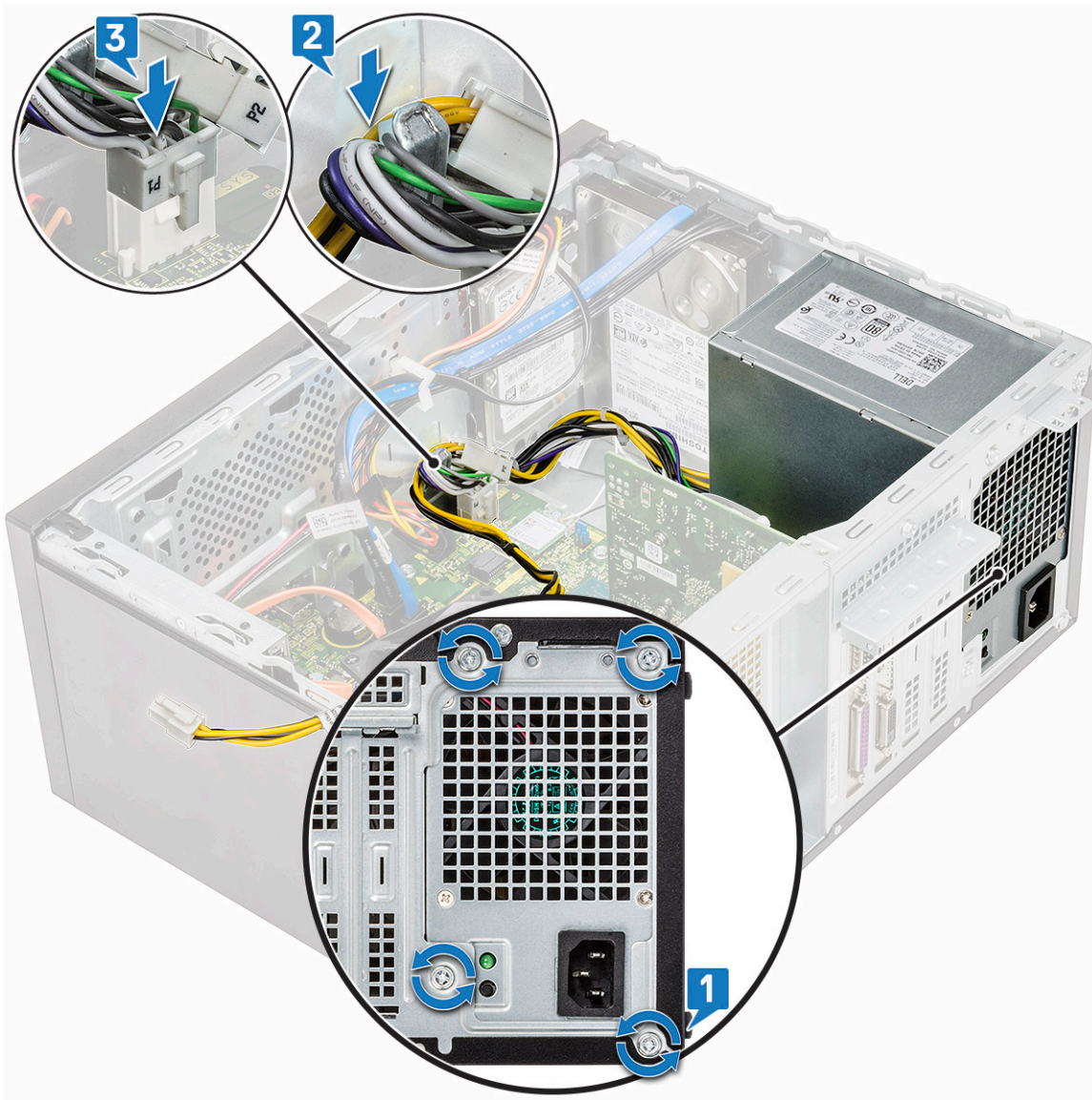
3. PSU ケーブルを固定タブに通して配線します [1、2、3]。
