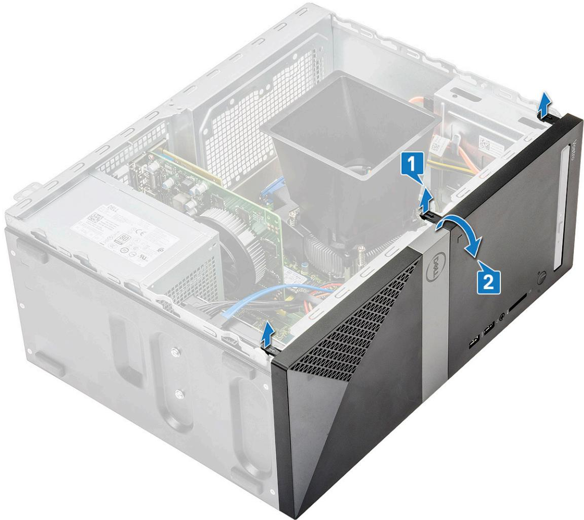
c Podignite kućište i uklonite prednji okvir sa kućišta
