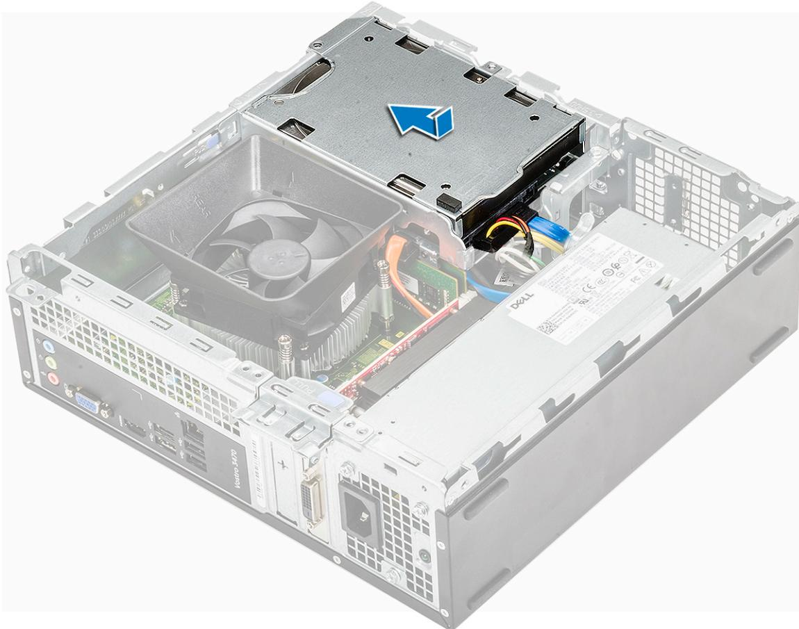
2. Ricollocare le due viti 6-32xL3.5 che fissano il telaio del disco rigido da 3,5 pollici al computer [1].
