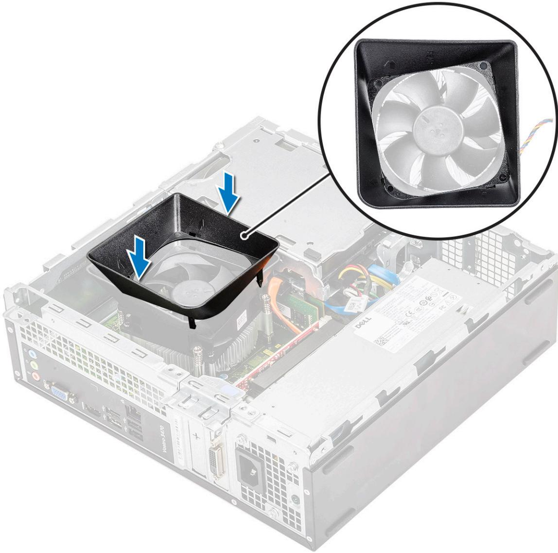
① 註：請確認散熱護罩的安裝方向是否正確，正確方向應是將散熱護罩上的「REAR」標記朝向系統後方。
