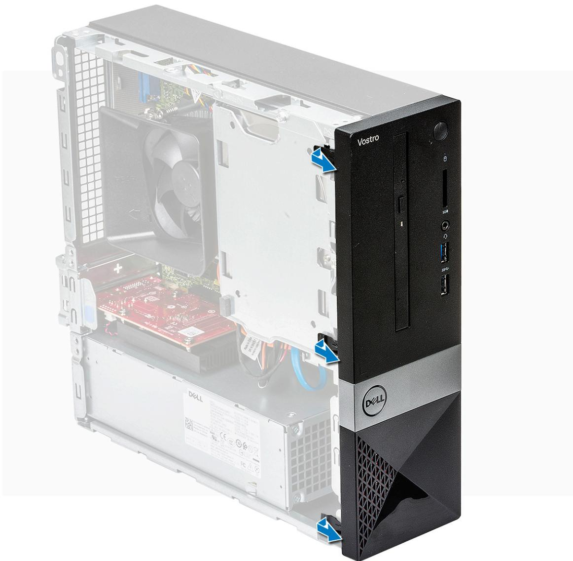
b 轉開前蓋，使其脫離電腦正面 [1]，並拉動前蓋上的彈片，使彈片從前面板插槽中鬆開 [2]。
