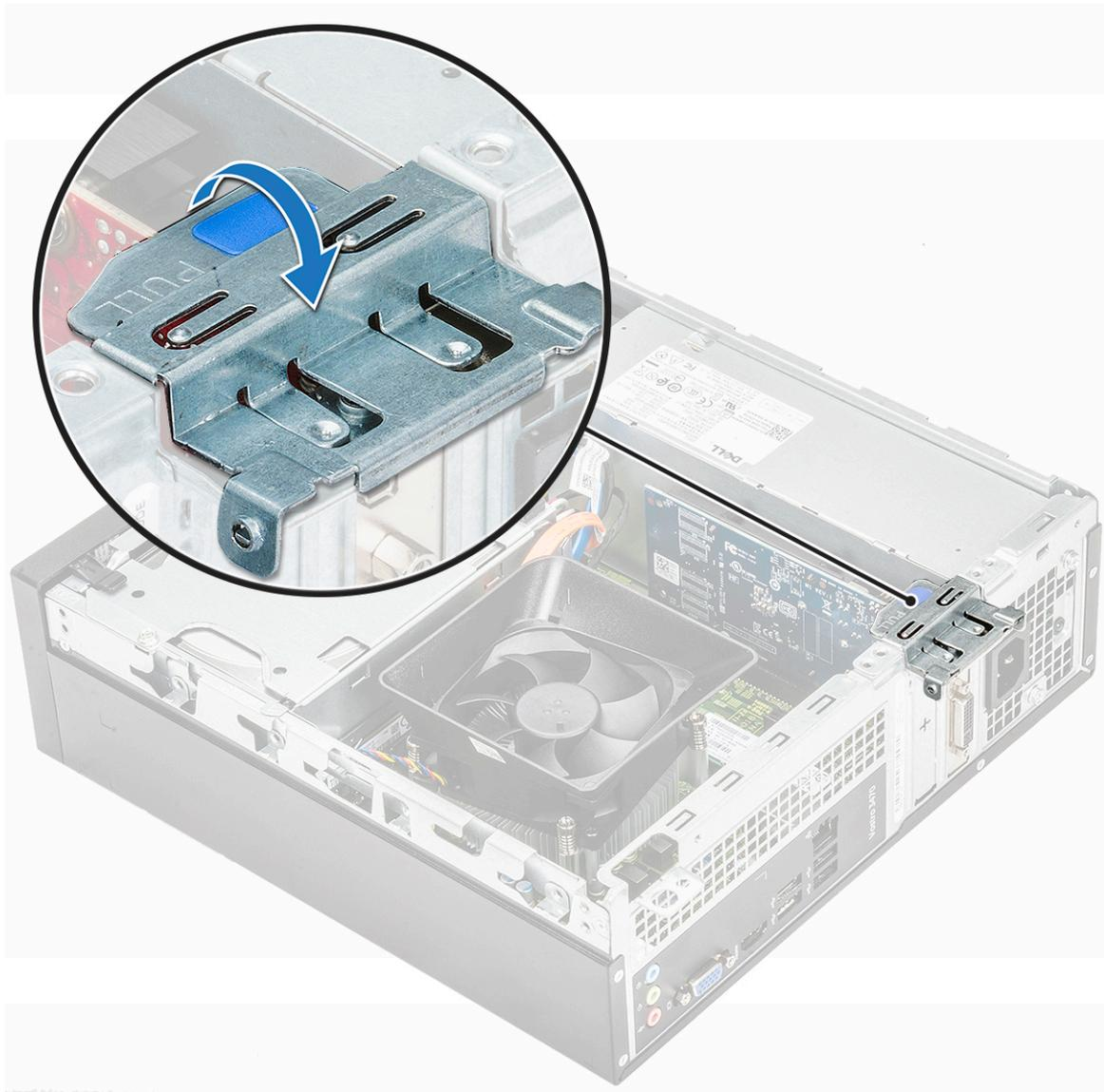
b 拉開插卡固定彈片 [1]，然後從電腦插槽卸下擴充卡 [2]。
