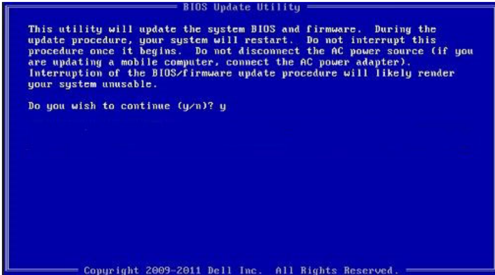
شكل 6. شاشة تحديث نظام الإدخال/الإخراج الأساسي (BIOS) عبر نظام تشغيل الأقراص (DOS)
