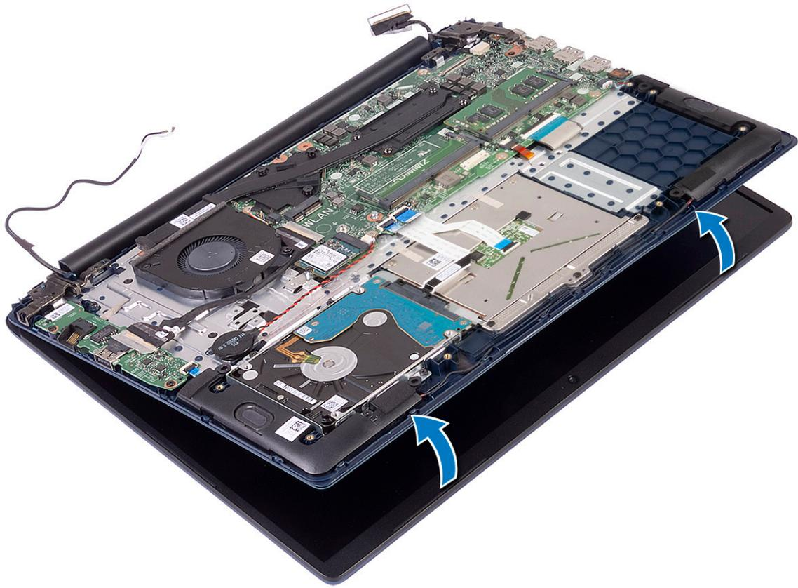
h Levante el ensamblaje de la pantalla para quitarlo del ensamblaje del teclado y el reposamanos.
