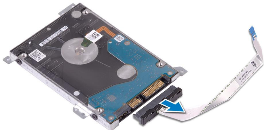
5. ハード ドライブブラケットをハード ドライブに固定している 4 本のネジ (M3x3) を取り外します [1]。
