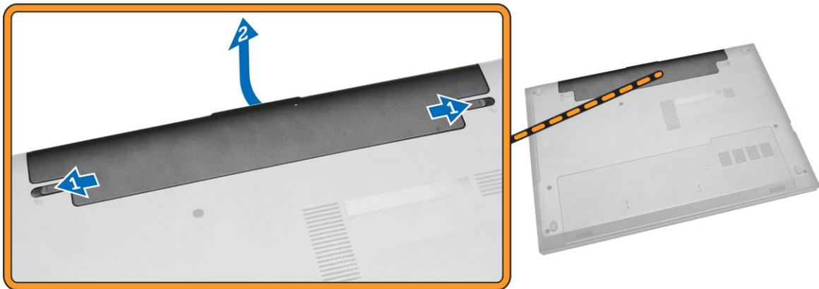
3. バッテリーを持ち上げて、コンピュータから取り外します。
