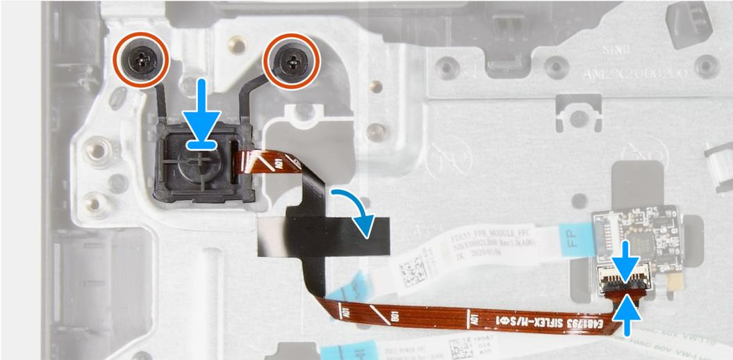
**NOTA:** Ao substituir/reinstalar o botão liga/desliga com leitor de impressão digital no Vostro 3501, um adesivo de Mylar deve ser posicionado no FPC do leitor de impressão digital para garantir que ele seja adequadamente aterrado no apoio para as mãos. O adesivo de Mylar está embalado juntamente com os conjuntos novos de botão liga/desliga de substituição com leitor de impressão digital.
