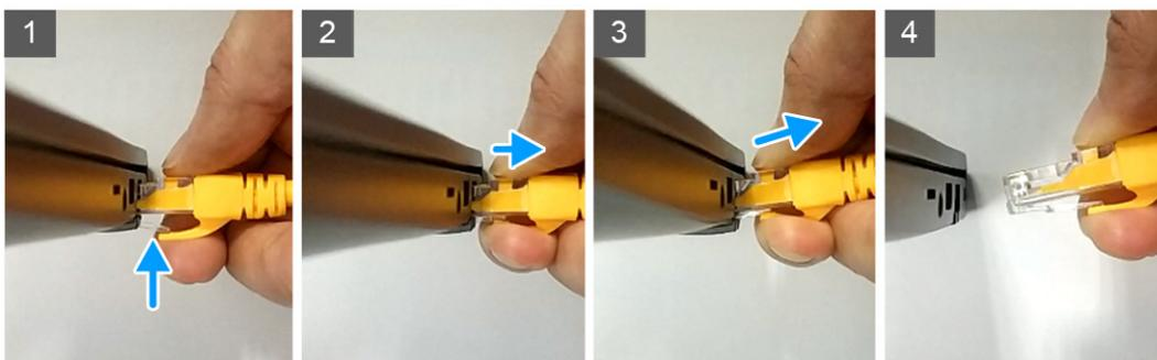
2. 從 RJ-45 連接埠 (乙太連接埠) 拔下乙太網路纜線時，請傾斜提起 [3、4]。
