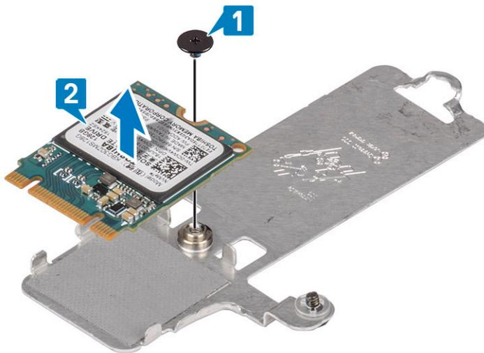
3. Aligned l'encoche du SSD avec la languette située sur l'emplacement du SSD.
