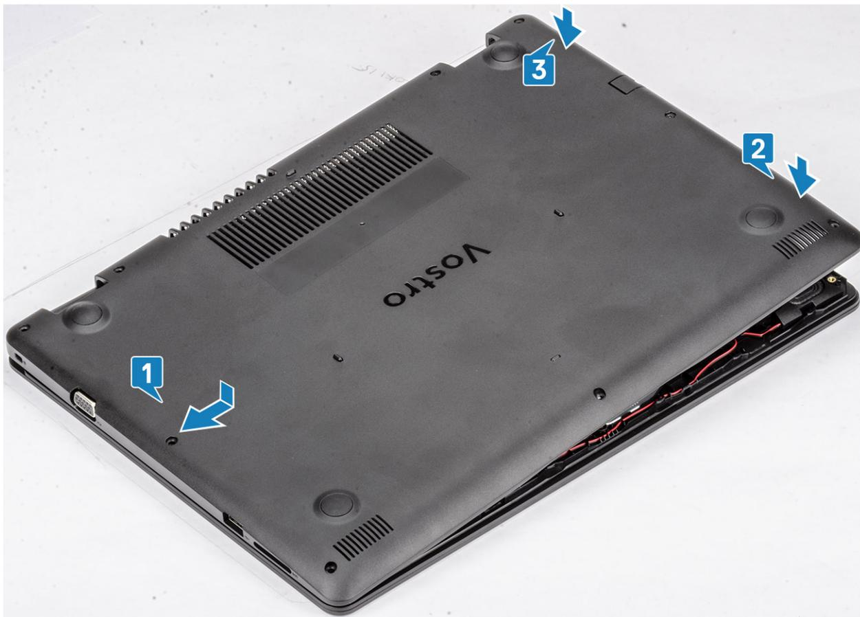
3. Serrez les trois vis captives et remettez en place les six vis (M2,5 x 6) qui fixent le cache de fond à l'ensemble repose-mains et clavier [1, 2].
