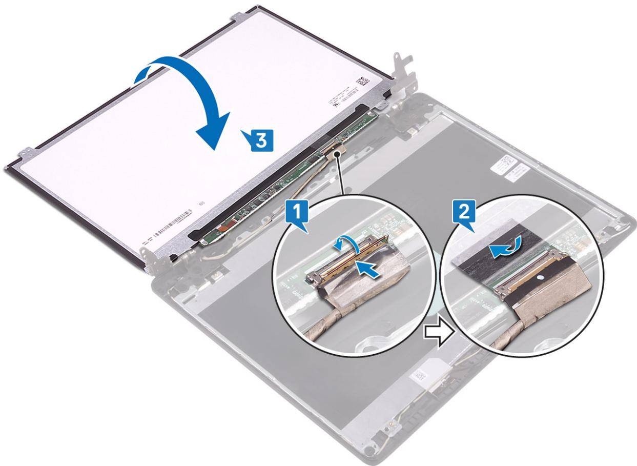
3. Retournez le panneau d'écran et placez-le sur l'assemblage du cache arrière de l'affichage et des antennes [3].
