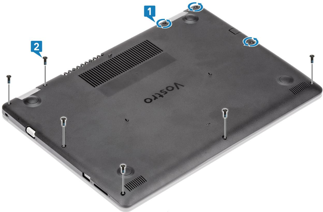
3. Faites levier sur le capot de la base dans le coin supérieur droit [1] et ouvrez le côté droit du capot de la base [2].
