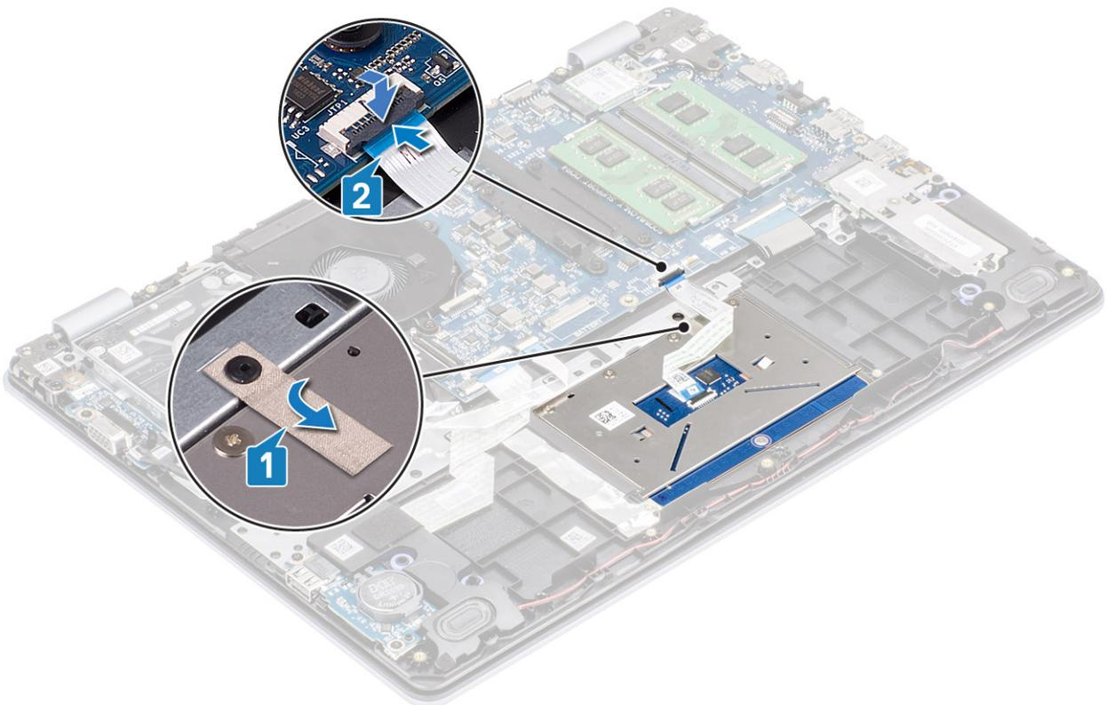
5. Placez le support du pavé tactile dans son emplacement situé sur l'ensemble repose-mains et clavier [1].
