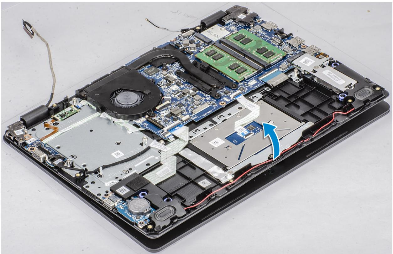
6 Faites glisser et retirez l'assemblage de repose-mains et de clavier hors de l'ensemble d'écran.
