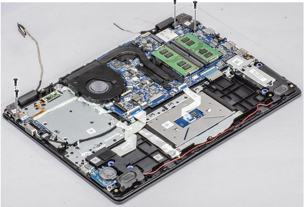
5 Soulevez l'ensemble de repose-mains et de clavier en l'inclinant .
