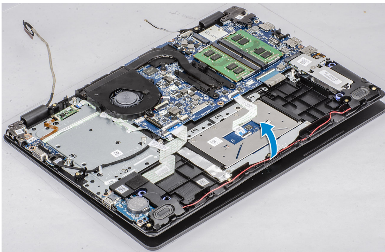
6 Skub og fjern håndfladestøtten og tastaturmodul af skærmmodulet.
