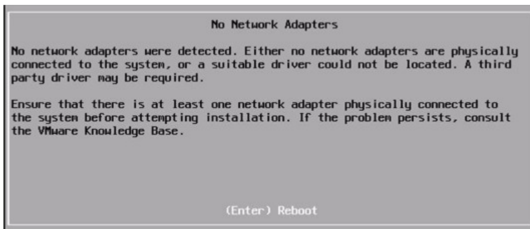
Figure 7. Erreur indiquant l'absence d'adaptateur réseau pendant l'installation d'ESXi
