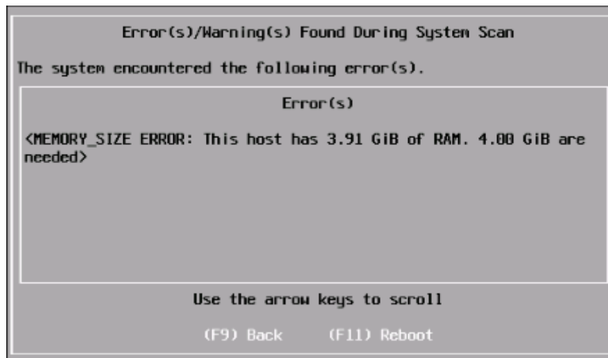
Figure 6. Échec de l'installation de VMware ESXi
