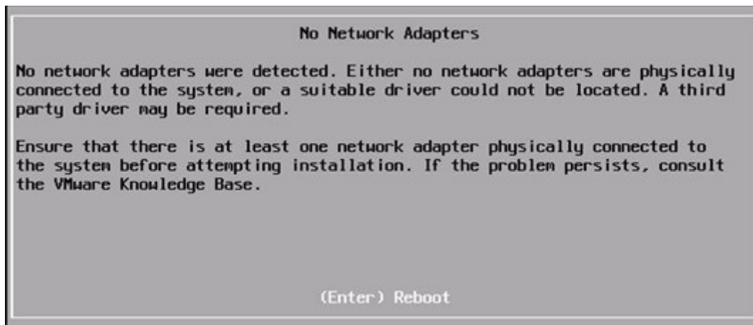
Figura 7. Error de ausencia de adaptador de red durante la instalación de ESXi
