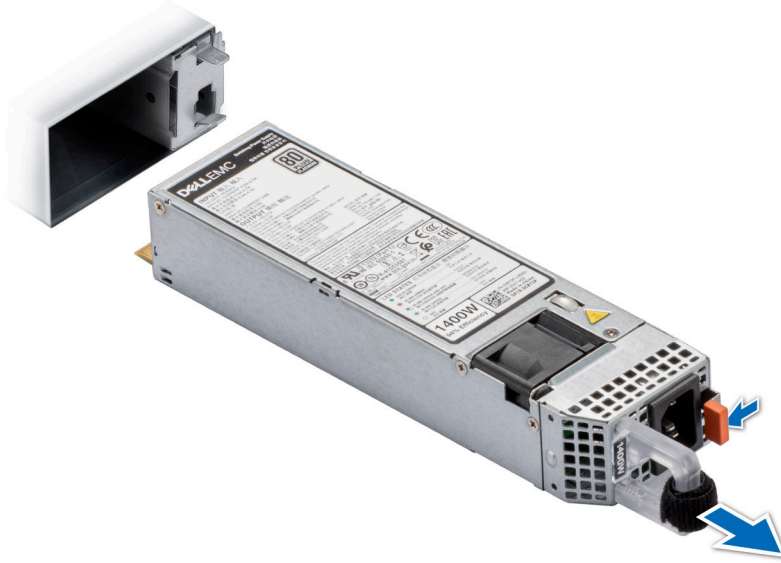
Rakam 171. 60 mm güç kaynağı ünitesini çıkarma
