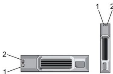
図 3. SCv3000 および SCv3020 拡張エンクロージャドライブのインジケータ
