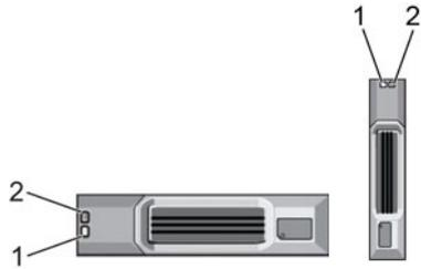
图 8: SCv2000/SCv2020 存储系统驱动器指示灯
