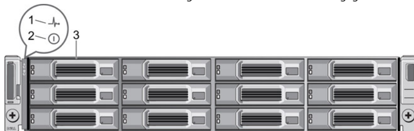
Abbildung 1. Anzeigen und Funktionen der Frontblende des SC100
