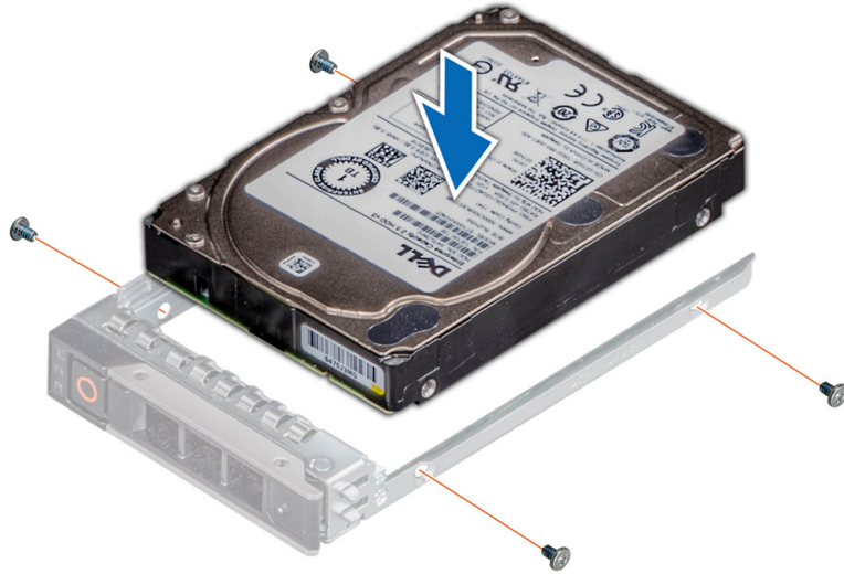
그림 23. 드라이브 캐리어에 드라이브 설치
