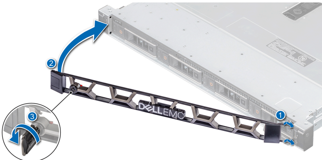
図 17. 前面ベゼルの取り付け
