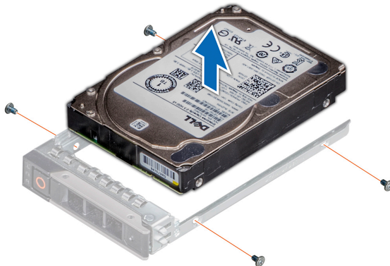
図 22. ドライブ キャリアからのドライブの取り外し
