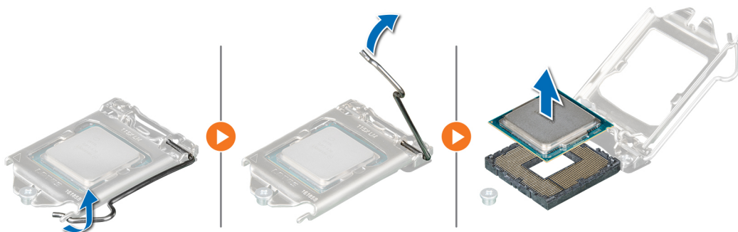
図 50. プロセッサの取り外し
