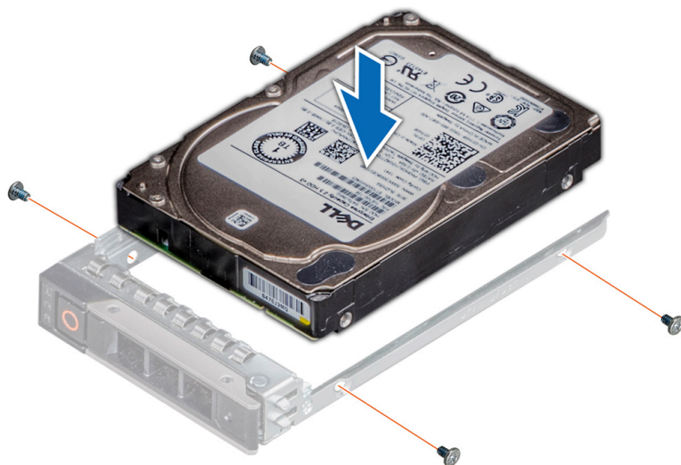
図 23. ドライブ キャリアへのドライブの取り付け
