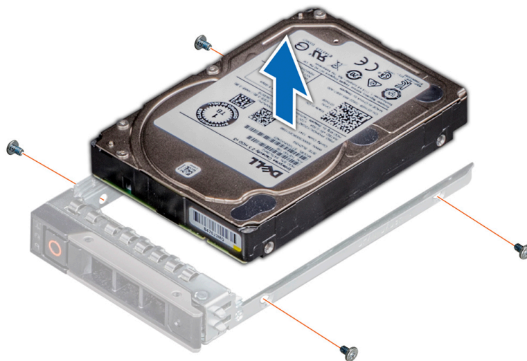
Figure 22. Retrait d'un disque dur installé de son support
