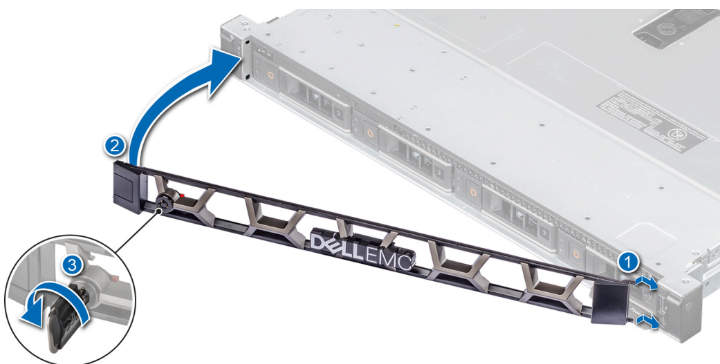
Figure 17. Installation du cadre avant
