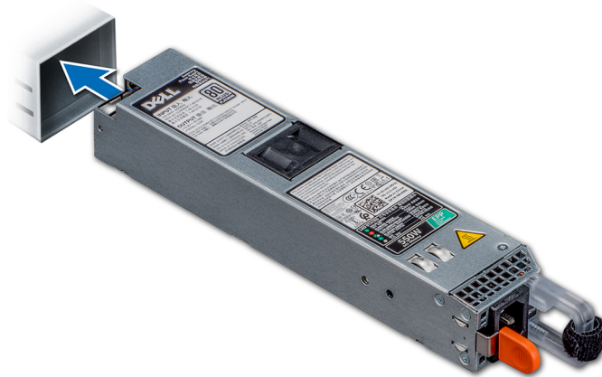
Figure 59. Installation d'un bloc d'alimentation
