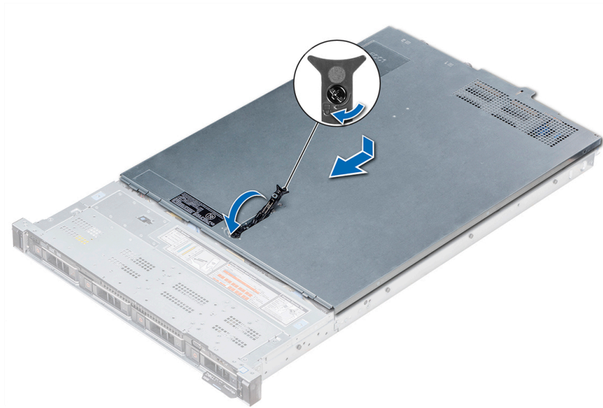
Abbildung 25. Installieren der Systemabdeckung
