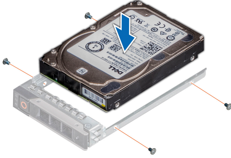
Rakam 59. Sürücü taşıyıcısına bir sürücü takma
