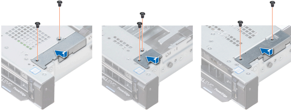
그림 85. 케이블 덮개 설치
