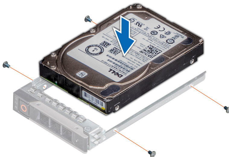
図 59. ドライブ キャリアへのドライブの取り付け
